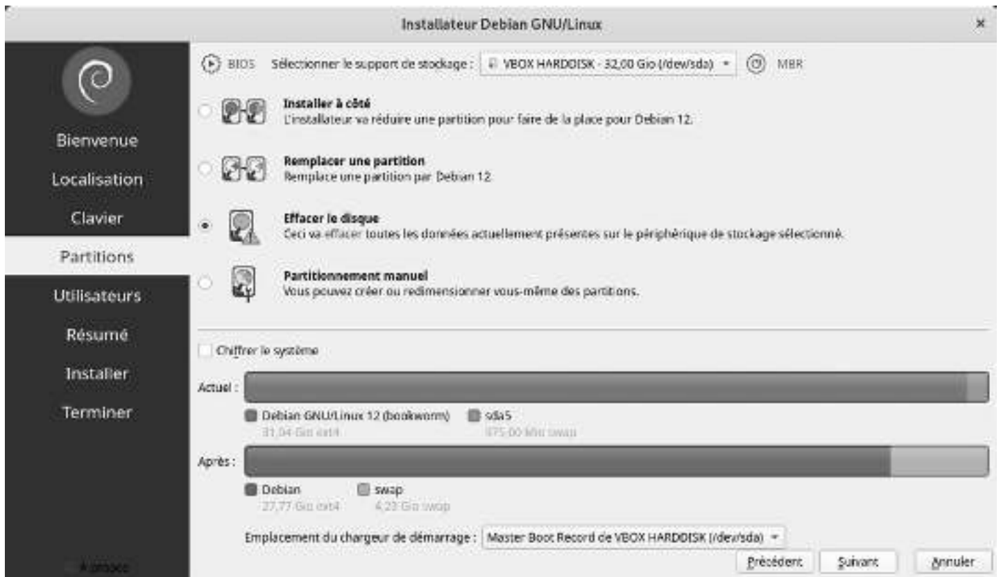
Installateur Calamares : schéma de partitionnement
